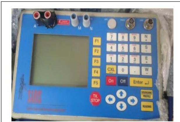
Figura 4– Resistivímetro SARIS, utilizado nos trabalhos de campo.
