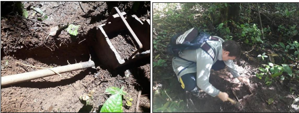
Figura 3- Utilização de caixa de aço com borda cortante, para coleta de monolito de solo e quantificação das raízes finas, em floresta com castanheiras na Resex Cajari.
