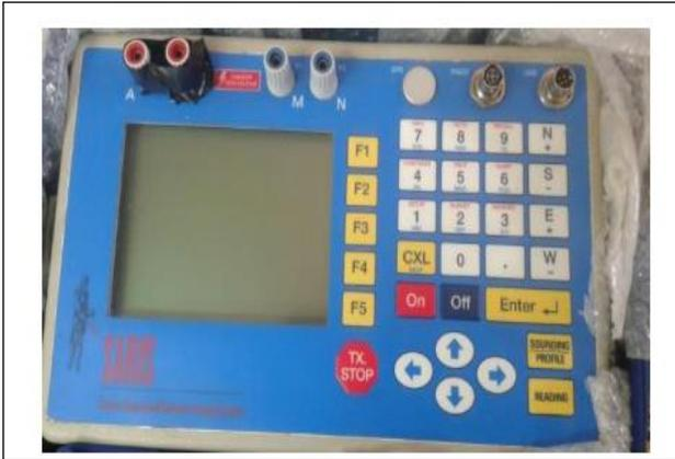
Figura 8– Resistivímetro SARIS utilizado nas medidas de resistividade elétrica na área de estudo.
