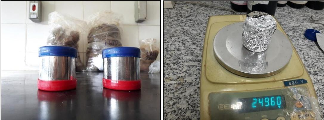
Figura 5- Cilindros com tampas, contendo amostras úmidas indeformadas de solo, e cilindro com amostra seca sendo pesado em uma balança de precisão.
