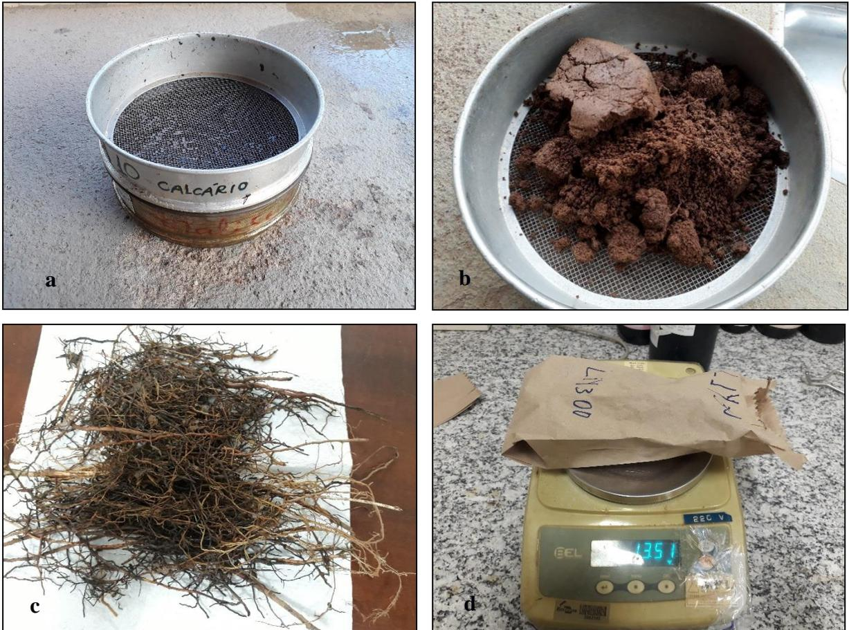
Figura 4- Procedimento de separação, secagem e pesagem de raízes finas.
