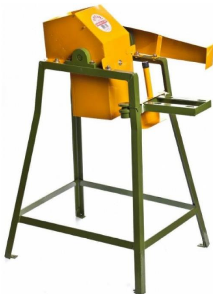
Figura 14 – Estrutura metálica do ralador de mandioca utilizado (BOTINI, 2012).
