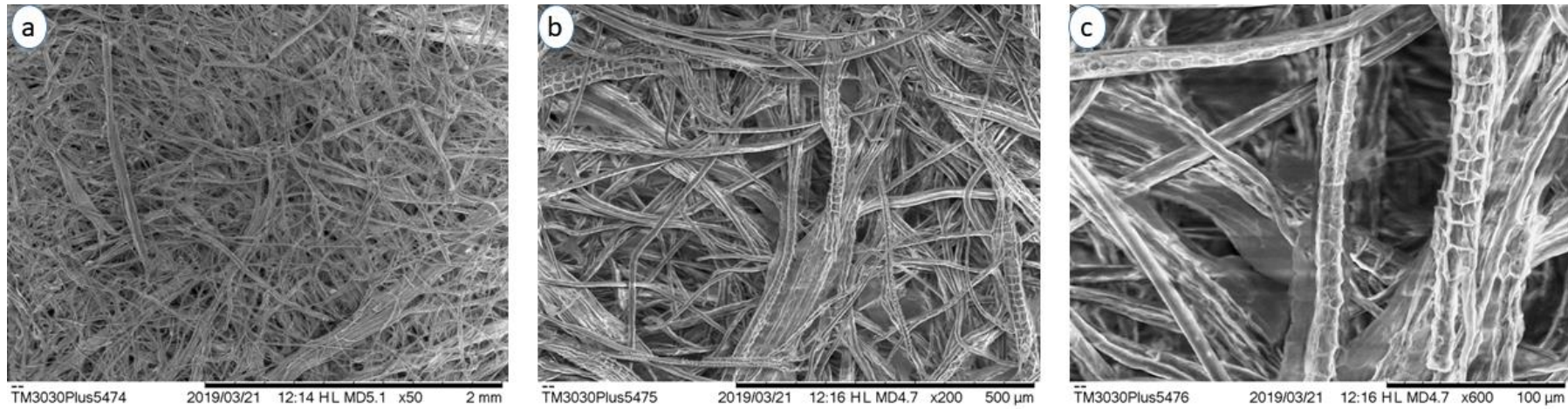
Figura 10 - Micrografias de MEV das fibras das folhas do açaizeiro branqueadas com 4 % de NaOH + H 2 O 2 25 % à 60 °C e ampliadas: (a) 50 vezes; (b) 200 vezes; e (c) 600 vezes.
