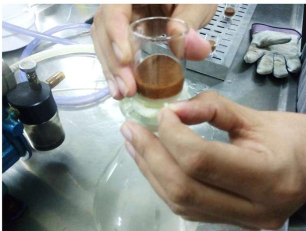
Figura 24 – Remoção de material solúvel em água fria/quente.
