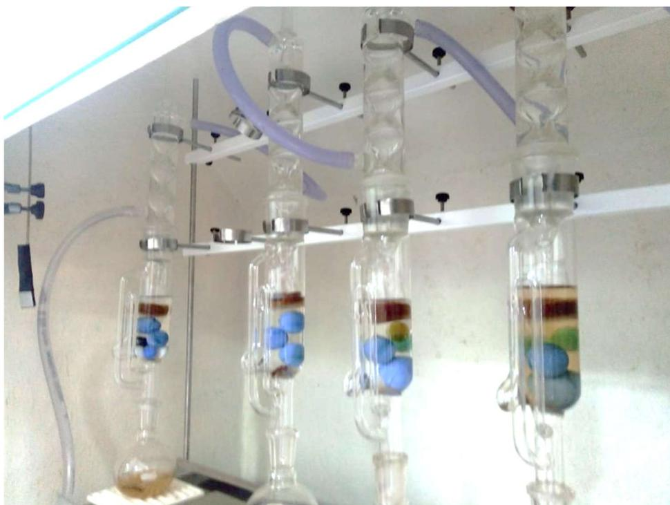
Figura 23 – Extratores Soxhlet em série.
