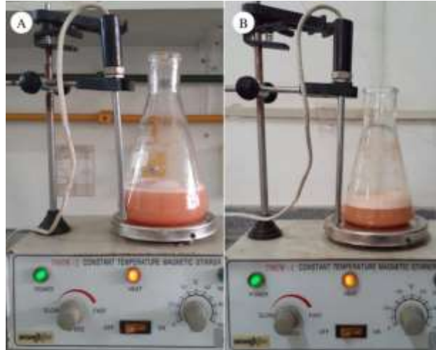
Figura 12 - Desmineralização das cascas do (a) M. amazonicum e (b) M. carcinus .
