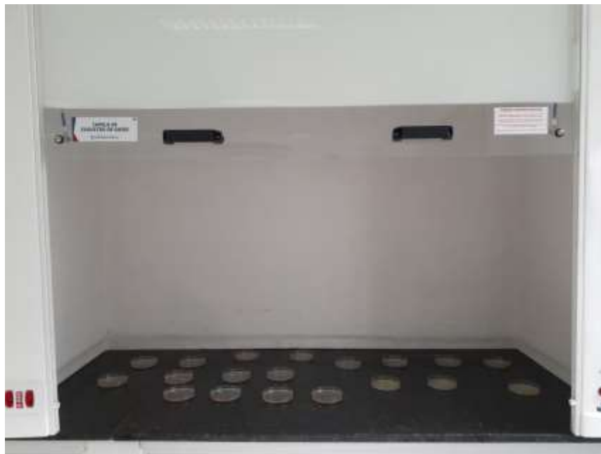
Figura 20 - Secagem dos filmes em capela.
