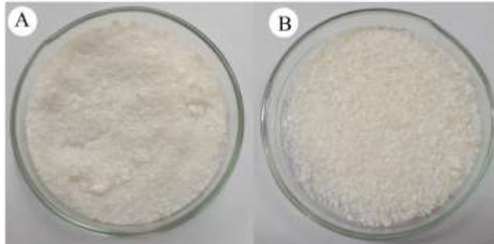
Figura 26 - Quitina isolada a partir do (a) M. amazonicum e (b) M. carcinus após a despigmentação.
