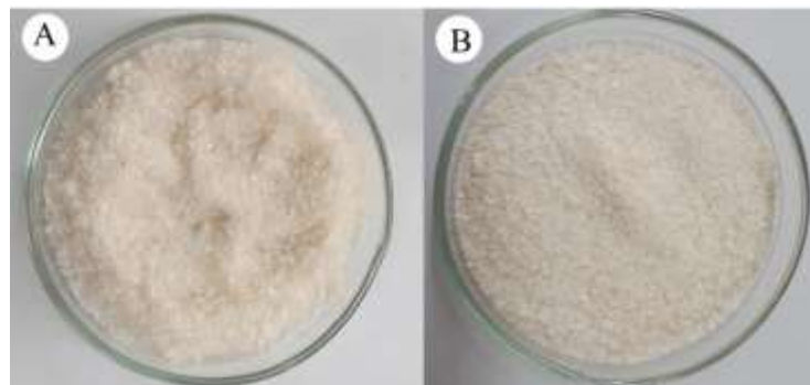
Figura 25 - Cascas do (a) M. amazonicum e (b) M. carcinus desproteínizadas.
