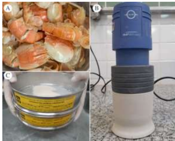
Figura 11 - Etapa de pré-tratamento. (a) cascas secas; (b) equipamento utilizado na moagem das amostras e (c) separação granulométrica das cascas secas.
