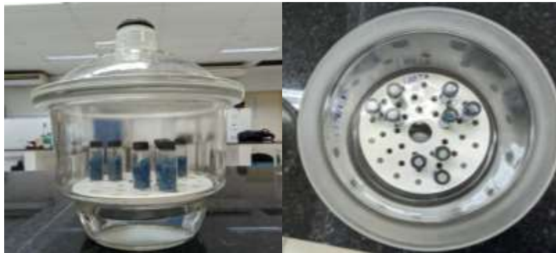
Figura 22 - Ensaio de TPVA e PVA nos filmes.
