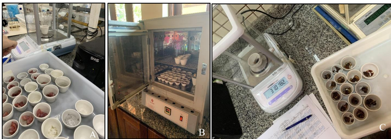
Figura 3 - Análise da umidade da carne suína comercializada em Macapá – AP no Laboratório de Química Orgânica e Bioquímica da UEAP. A) Pesagem das amostras, B) Amostras submetidas à estufa (105°C) por 24h e C) Pesagem das amostras após estufa. Fonte: Da autora.
