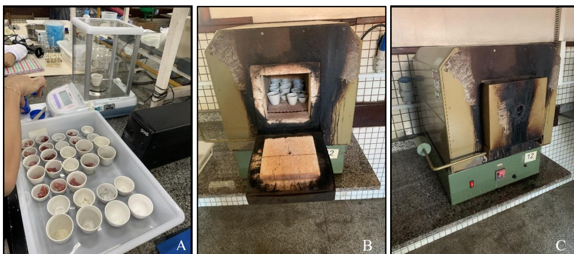
Figura 5 - Análise de cinzas da carne suína comercializada em Macapá – AP no Laboratório de Química Orgânica e Bioquímica da UEAP. A) Pesagem das amostras, B) Mufla contendo as amostras e C) Amostras submetidas à 550°C. Fonte: Da autora.
