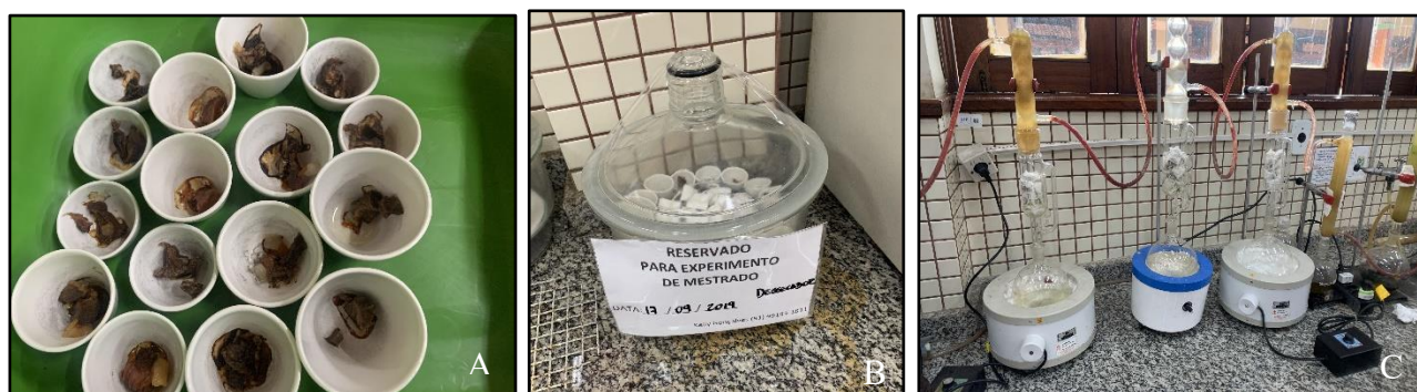
Figura 6 - Análise de lipídeos da carne suína comercializada em Macapá – AP no Laboratório de Química Orgânica e Bioquímica da UEAP. A) Separação das amostras para empacotamento, B) Amostras reservadas no dessecador e C) Amostras no soxhlet. Fonte: Da autora.
