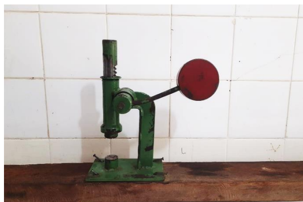
Figura 4 – Descascador manual usado no Laboratório de Sementes da Embrapa AP para descascar as castanhas-da-amazônia utilizadas no estudo.
