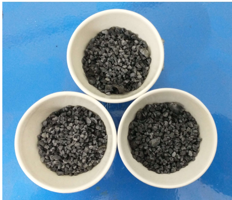
Figura A2 – Caroços moídos e pirolisados à 500 °C. Fina camada de cinzas sob o material. Fonte: Elaborado pelo autor.
