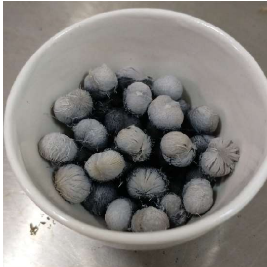
Figura A1 – Caroços não moídos e pirolisados à 500 °C. Os tons em cinzas ao branco são as cinzas do material. Fonte: Elaborado pelo autor
