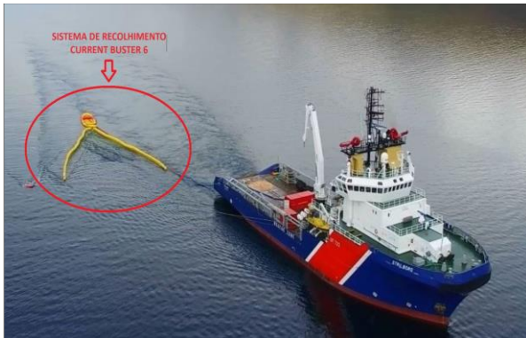
Figura 20 - Sistema de Recolhimento de óleo vazado Current Buster 6. Fonte: Markleen (2023).
